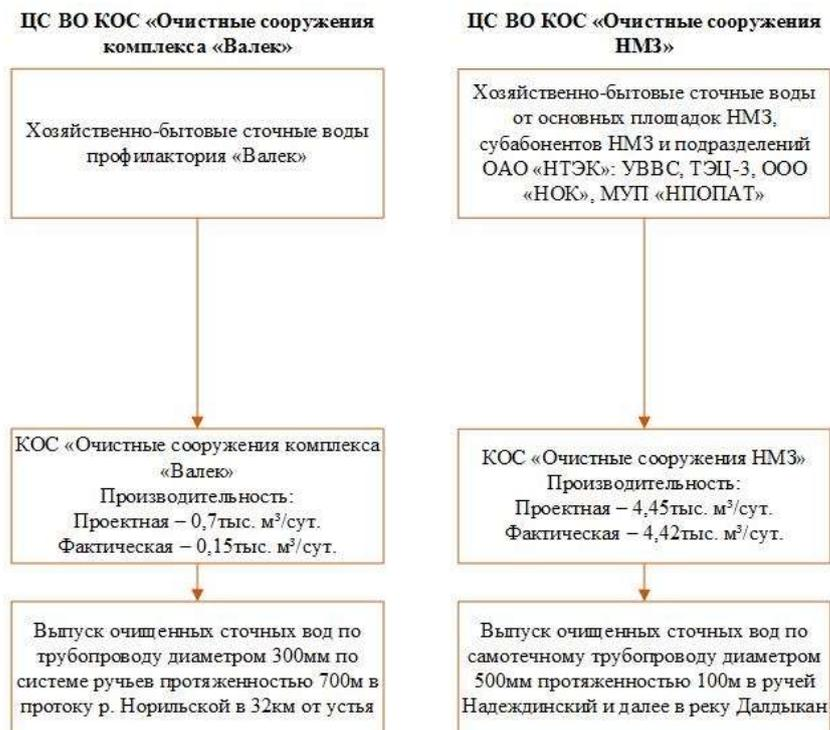
**Рисунок 2.1.3 – Структурная схема централизованного водоотведения на территории КОС Валек, КОС НМЗ МО город Норильск**
