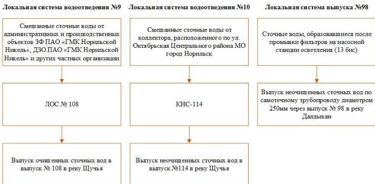
**Рисунок 2.1.5 – Структурная схема локальных систем водоотведения № 9, 10, выпуска № 98 на территории МО город Норильск**
